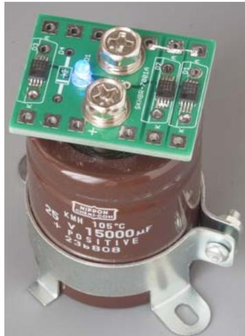
図4 ケミコンへの取り付け
